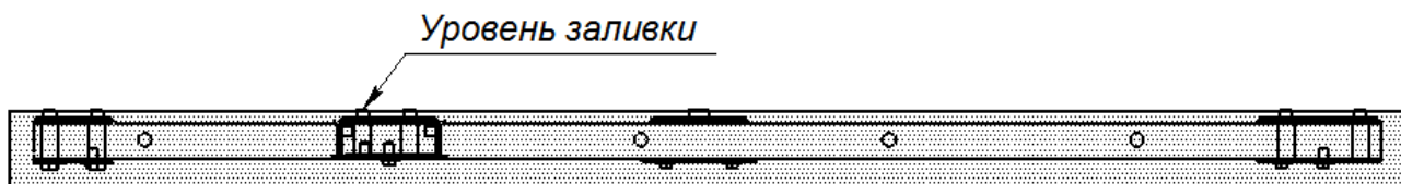
Рисунок 3. Схема установки и заливки рамы
